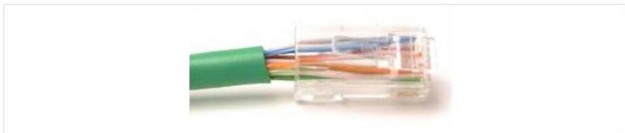
La figure suivante montre un câble UTP correctement terminé. C'est un bon connecteur avec des fils qui ne sont pas torsadés, mais seulement dans la mesure nécessaire pour fixer le connecteur.
