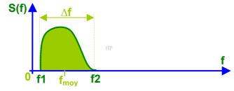
Dans le cas de la transmission d'un message sonore en « haute-fidélité », l'intervalle **[f1,f2]** couvrira la totalité de la bande caractérisant une audition humaine : f1=20Hz et f2=20kHz. Pour des applications où l'on peut se contenter d'une moindre fidélité de reproduction des messages sonores, et pour simplifier la transmission, on limitera la bande passante des signaux.
